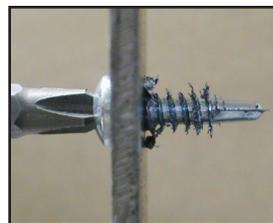
Terminé la operación de atornillado asegurándose que la cabeza presione el elemento a fijar.
