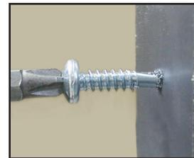
Coloque el tornillo perpendicular a la superficie a taladrar.
