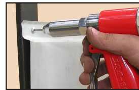
Inserte cabeza del remache en la perforación.
