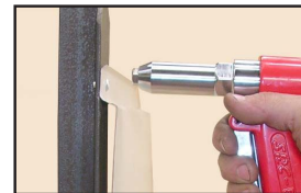
Se corta el vástago del remache obteniendo una fijación fuerte y confiable.
