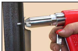
Introduzca mandril en el Accione la remachadora. vástago del remache .
